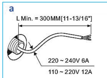
\*Si consiglia per l'installazione degli allacci elettrici **non a vista**, un cavo in uscita dal muro di lunghezza **non inferiore ai 300 mm con sezione cavo da 1.5 mmq**
